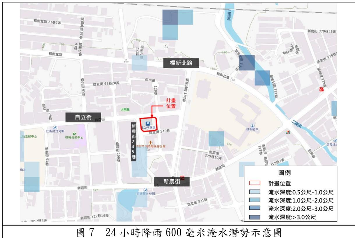
圖 7 24 小時降雨 600 毫米淹水潛勢示意圖
